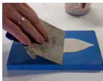
Versez la quantité désirée d'A1 dans le moule et grattez l'excès d'A1 avec un couteau à mastic.
