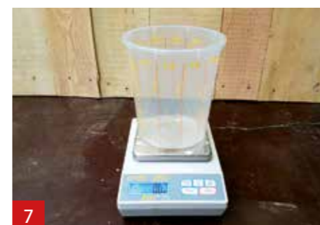
7 Placez un gobelet sur la balance. Calibrez la balance avec le gobelet (0,0 g).
