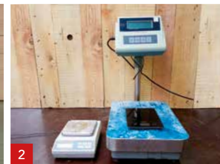
2 Mettez en place une balance pour peser le liquide A1 et la poudre A1.
