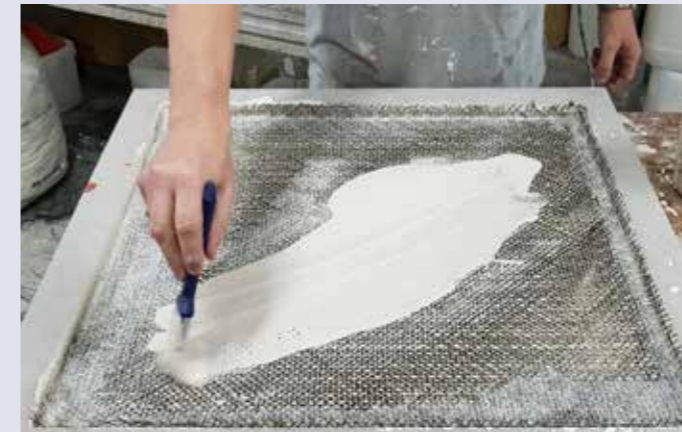
Pour stratifier, il faut mettre une couche humide sur une autre couche humide. Un moyen rapide d'appliquer A1 est d'utiliser un pinceau ou un rouleau.
