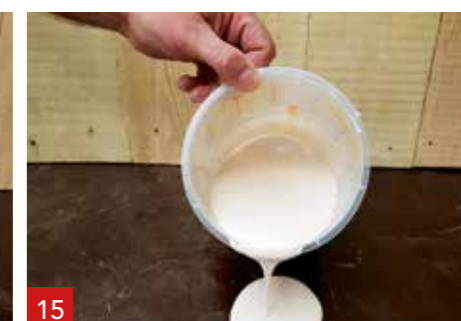
15 A1 est prêt pour la stratification, le moulage ou la pulvérisation. Temps de travail de 20 - 25 minutes.
