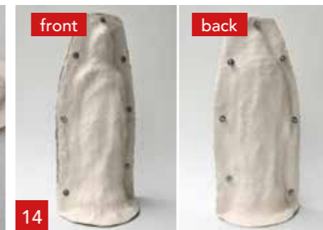
11 Laissez sécher le gabarit de support A1 pendant 60 minutes.
