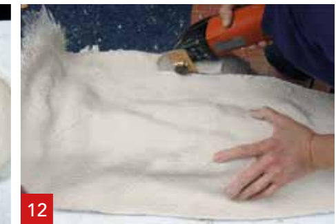
9 Appuyez sur la fibre de verre triaxiale A1. La fibre peut prendre facilement la forme voulue.
