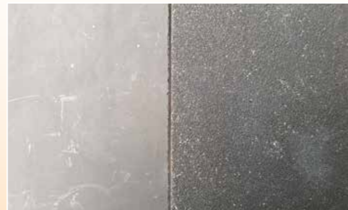
Panneau A1 avec du sable directement après démoulage.
