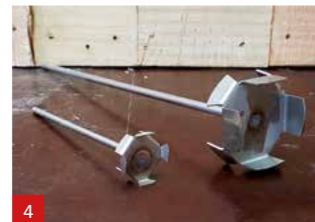
4 Utilisez le malaxeur A1. Petit malaxeur : jusqu'à 1,5 kg d'A1. Grand malaxeur : 1,5 kg ou plus A1
