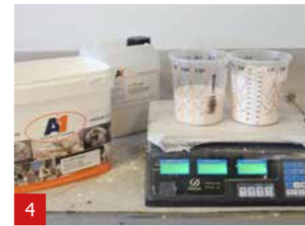
4 Pesez 1 mesure de liquide A1 et 2 mesures de poudre A1 et mélangez. L'A1 est prêt dès que vous n'avez plus de grumeaux ou de bulles d'air.
