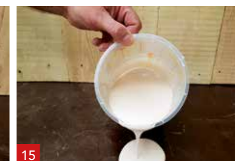
15 A1 jest gotowy do laminowania, odlewania lub natryskiwania. Czas obróbki wynosi 20-25 minut.
