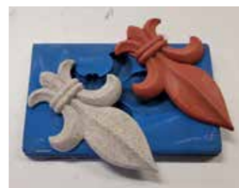
Wynik po wyschnięciu i wyjęciu; utwardzony odlewany obiekt, dokładna kopia formy.
