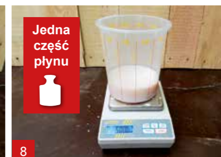
8 Zważ jedną część płynu A1. W tym przykładzie stosujemy 500 g płynu A1.
