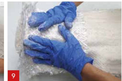
6 Nałóż włókno Triaxial A1 na mokre A1. Kontynuuj, aż cała forma silikonowa zostanie pokryta A1 i warstwą włókna A1 Triaxial.
