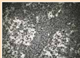
Powiększone zdjęcie paneli A1 z A1 Sealer po 4 latach po słonecznej stronie.
