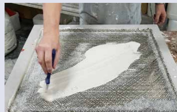
Aby laminować, musisz pracować na mokro. A1 można w szybki sposób nakładać za pomocą pędzla lub wałka.
