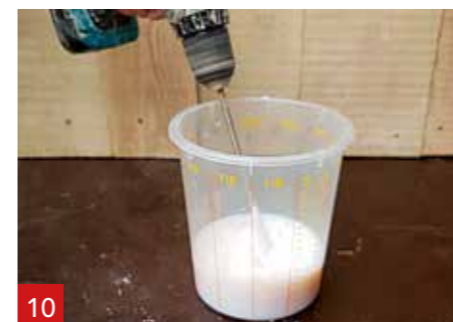
10 Włóż mieszadło (pod kątem) do pojemnika z płynem A1 i stwórz wir.
