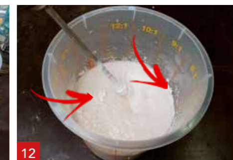
12 Mieszaj mieszadłem, aż znikną wszystkie grudki (±1 min.) uzyskując gładki materiał.
