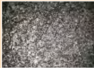
Фото тієї ж панелі А1 після повторного нанесення А1 Sealer PLUS
