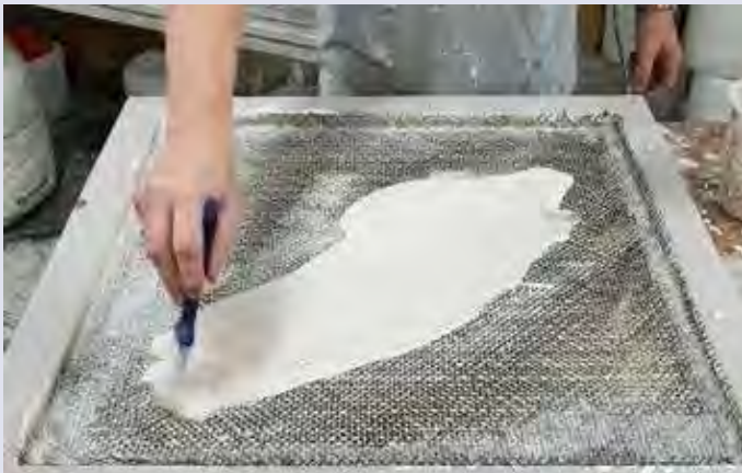
Для ламінування потрібно працювати «вологим по вологому». Швидкий спосіб нанесення А1 – пензлем або валиком.
