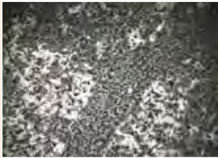
Масштабне зображення панелей А1 з А1 Sealer PLUS після 4 років на сонячній стороні
