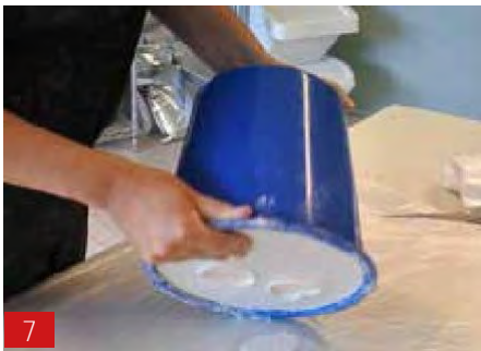
7 Обережно переверніть відру, щоб затверділий альгінат вислизнув із відра разом із затверділим A1
